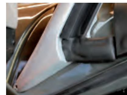
■ Abdichtung Frontscheibe zur Tür
